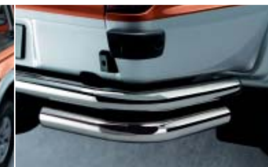
Hátsó aláfutásgátló sarokvédőkkel. A hátsó aláfutásgátló minden XLT modell alapfelszereltségébe tartozik, és utólagosan is beszerelhető az összes 4WD (4-kerék-hajtás) XL modellbe. Ezenkívül a hátsó sarokvédő is felszerelhető (hamarosan kapható).
