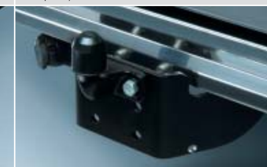
Rögzített vonóhorog az összes 4WD (4-kerék-hajtás) modellhez. A vonóhorog tengelyt különböző pozíciókban lehet felszerelni (lehet hogy hivatalosan engedélyeztetni kell az adott országban érvényes előírásoknak megfelelően). 7 + 13 pólusú elektromos készlettel kapható.
